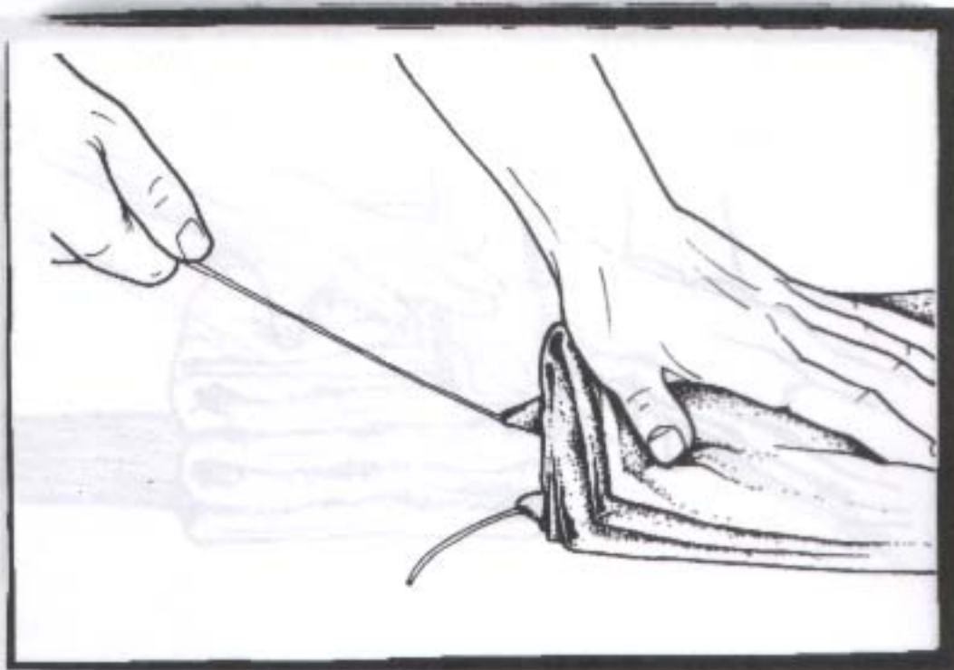
Fig. 19 IMPORTANTE: A ripiegamento ultimato, togliere la funicella dalle asole. Warning: pull the rope out of the buttonholes when folding is completed.
